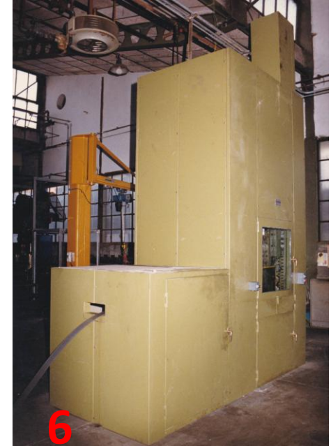
Alcuni degli interventi progettati e prodotti: Cabine Fonoisolanti per Mulini e Presse (1-6) Silenziatori d'Aria (3-5) Trattamento Ambientale (2) Cabina "riposo acustico uomo" (4)
